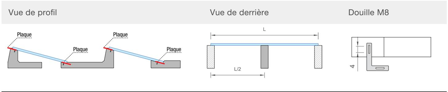
**UTILISER LA FENTE DE 4CM POUR FIXER LA PLAQUE AUX BALLASTS CENTRAUX DE RENFORT**
