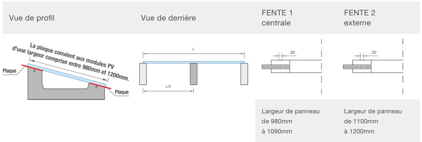
**UTILISER L'UNE DES DEUX FENTES DE 30 MM POUR FIXER LA PLAQUE AUX BALLASTS CENTRAUX DE RENFORT EN FONCTION DE LA LARGEUR DU PANNEAU**
